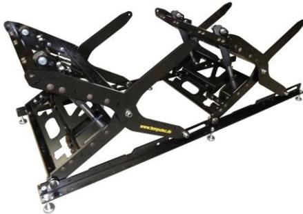
Doppelscheren-Tischgestelle in extrem robuster Vollstahl-Ausführung mit ca. 300 kg Eigengewicht und 2500kg nominaler statischer Traglast. Bodenschiene mit je 3 Nivellierfüßen zum Ausgleich von Bodenunebenheiten bis zu 5cm am Aufstellort. Die Grundhöhe der verstellbaren Gestelle gewährleisten je nach Typ Arbeitshöhen von min. 300mm bzw. 650mm.
